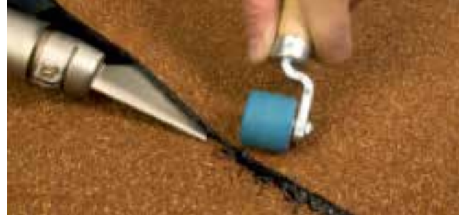
TRIAC se speciální tryskou pro svařování bitumenu.
