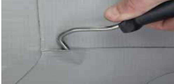
Zkouška svaru zkušebním háčkem.
